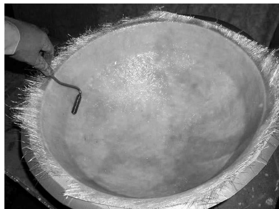
Figura 12. Fabricación de un domo por estratificación manual [22].
