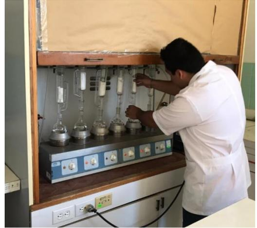
**Imagen B. 10.** Determinación de grasa mediante el equipo Soxhlet en el INIAP
