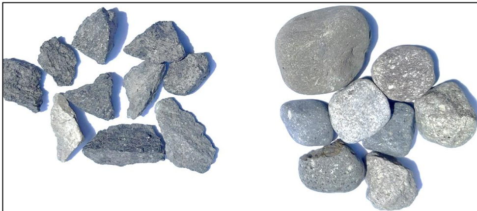
Figura 3. Áridos angulares y redondeados
