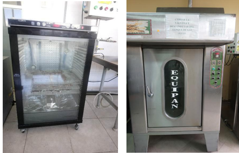
Secado de semillas de Tamarindo (Secador de bandejas y Tostado)
