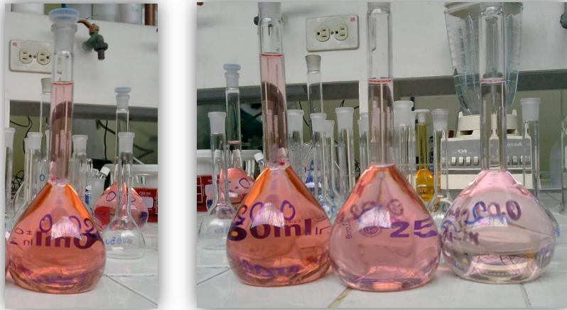
Fotografía K-13. Color rojo para el análisis de interferencia del método de nitritos.
