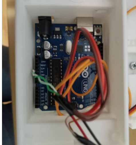
Fig. 71: Placa de control Arduino UNO colocada dentro del prototipo.
