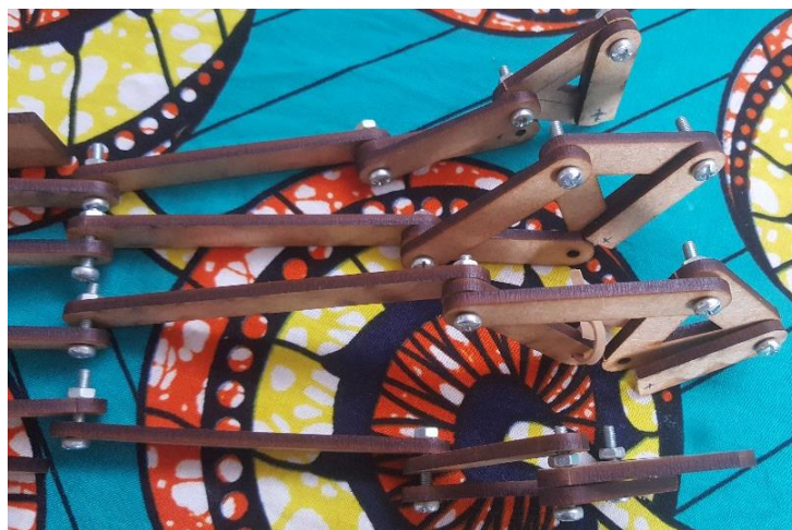
Fig. 34: Prototipo realizado en MDF Elaborado por: Investigador
