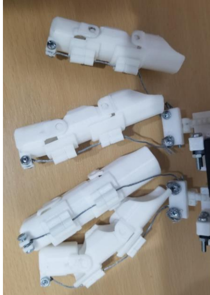
Fig. 73: Estructura de los dedos ensamblada. Elaborado por: Investigador
