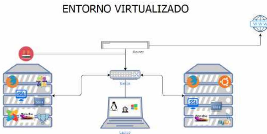
Figura 3.24: Entorno virtualizado para explotación de vulnerabilidades
