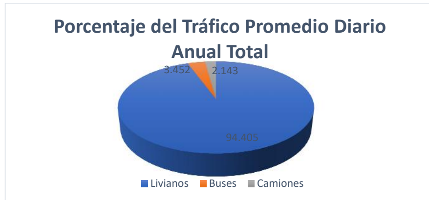
Gráfica 11. Porcentaje de Participación de Tipos de Vehículos en el TPDA total
