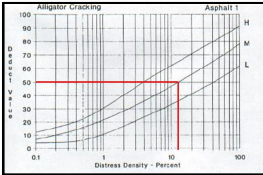
Gráfica 19. Valores Deducidos para Piel de Cocodrilo Severidad M Unidad de Muestreo U2
