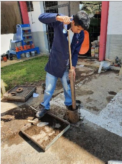
Compactación de muestra con humedad óptima (CBR)
