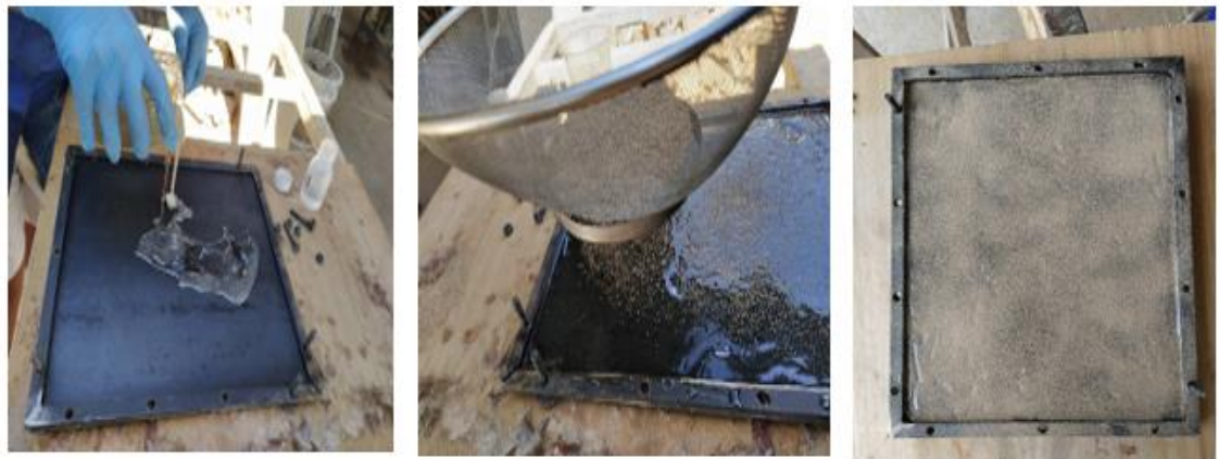
Figura 16: Colocación y distribución de la matriz y del refuerzo
