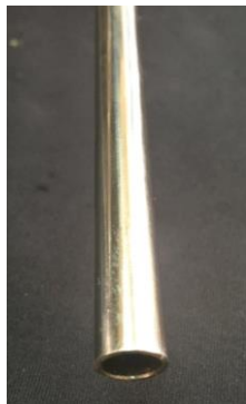
Fig. 37 Tubing de acero inoxidable Fuente: Autores
