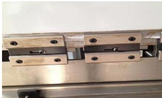
**Figura 23.-** Sistema del troquel superior e inferior
