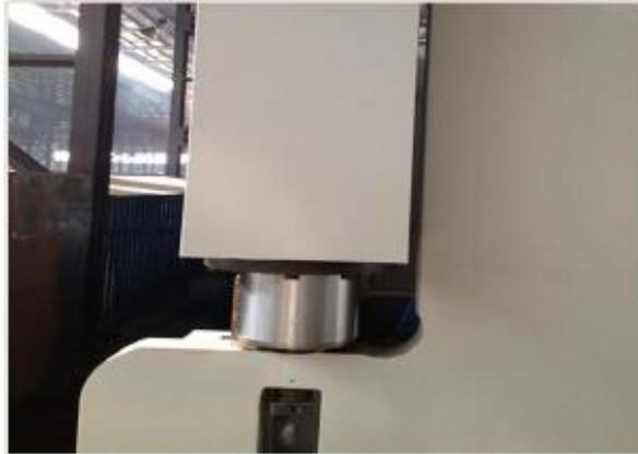
**Figura 24.-** Sistema de elevación por cilindros hidráulicos
