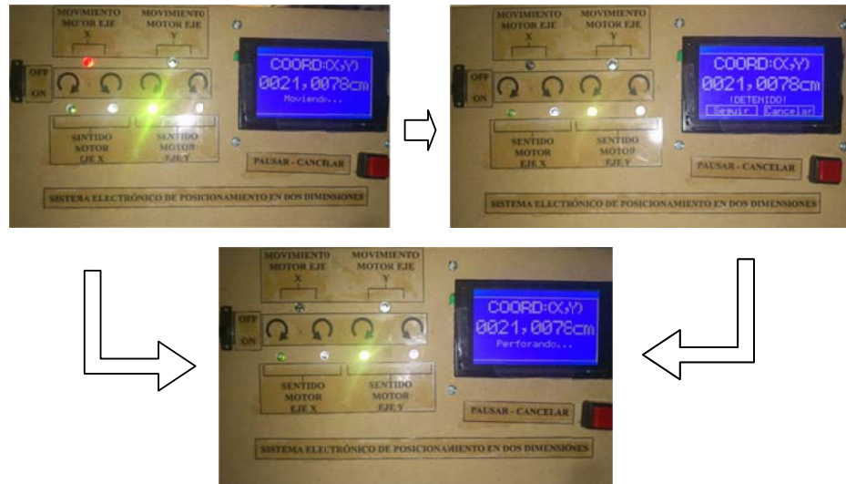
Figura B5. Etapa de Perforación del Sistema Electrónico de Posicionamiento Fuente: Investigador
