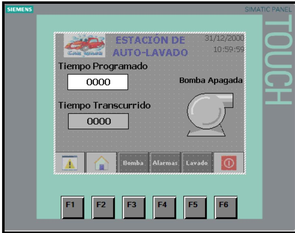
**Figura 20:** Pantalla tiempo de funcionamiento de la bomba de agua
