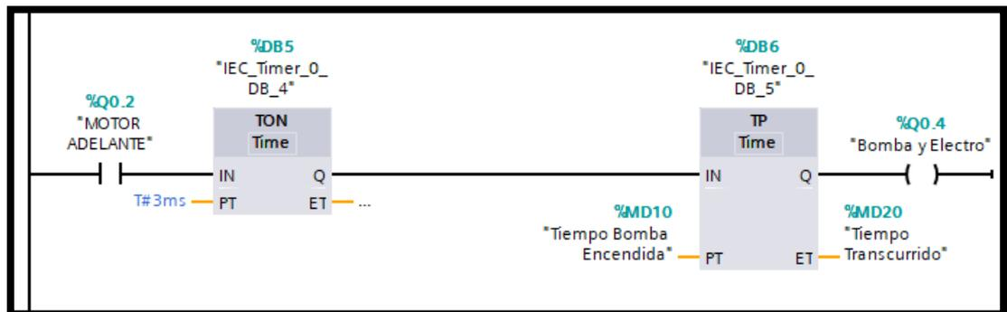
**Figura 21:** Programación del tiempo de apagado de la bomba
