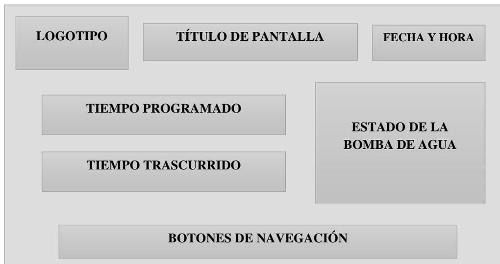
**Figura 19:** Diseño de la pantalla de la bomba de agua
