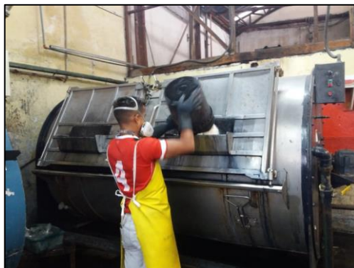
Figura 36. Etapa de fijado y suavizado
