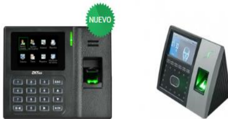
Figura 36. Sistema control de acceso
