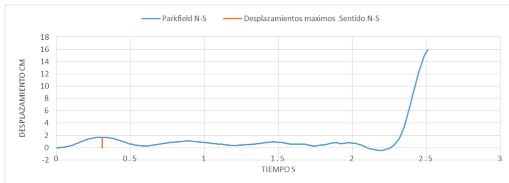
Figura 125: Desplazamientos Parkfield sentido Norte-Sur
