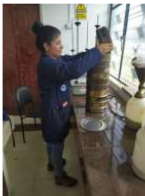
Figura 78. Colocación de la muestra para ensayo granulométrico
