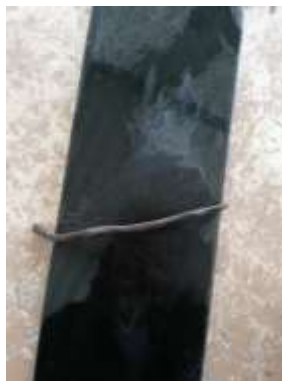
Figura 27. Rollitos de 3 mm de diámetro
