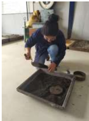
Figura 76. Toma de muestra para contenido de humedad
