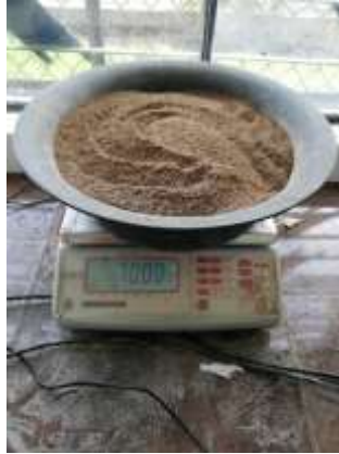
Figura 81. Muestra ensayo Próctor Modificado (7 Kg)
