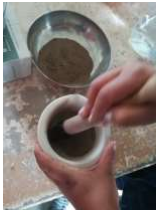
Figura 73. Preparación de muestra para límites de Atterberg
