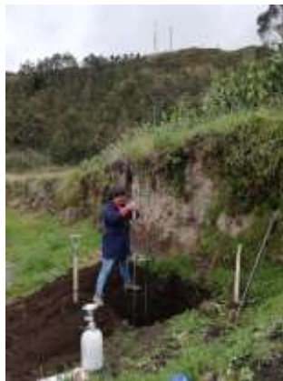
Figura 71. Ejecución Ensayo DCp
