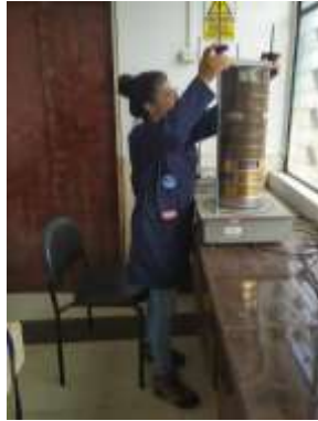
Figura 25. Colocación de la muestra en la tamizadora
