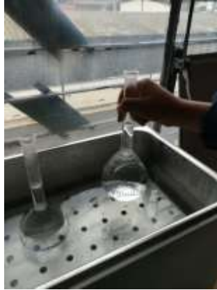
Figura 75. Colocación del picnómetro + agua en el baño María
