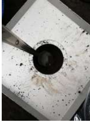
Figura 72. Extracción del suelo, hueco del ensayo cono y arena
