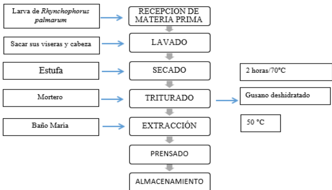
Figura 16. Diagrama de proceso para la extracción del aceite de la larva Rhynchophorus Palamrum
