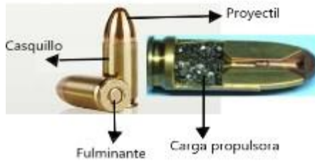
Figura N° 12 Partes de una munición [17]
