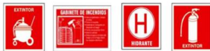
Figura N° Señalización de equipos de extinción [35]
