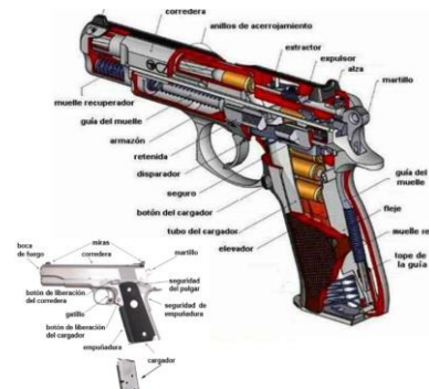
Figura N° 7 Partes de una pistola [16]
