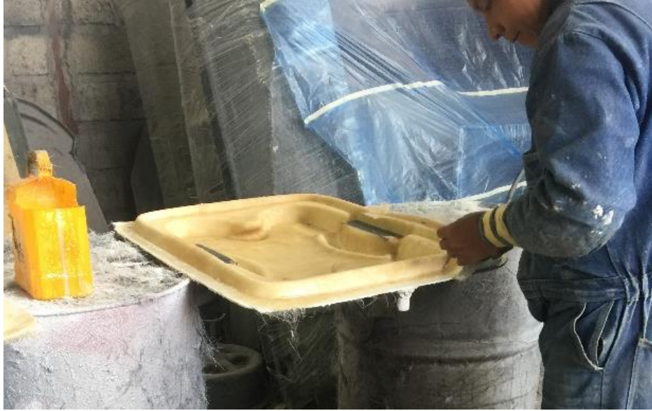
Figura 6 Corte de exceso de fibra Fuente: Empresa Master Fibra
