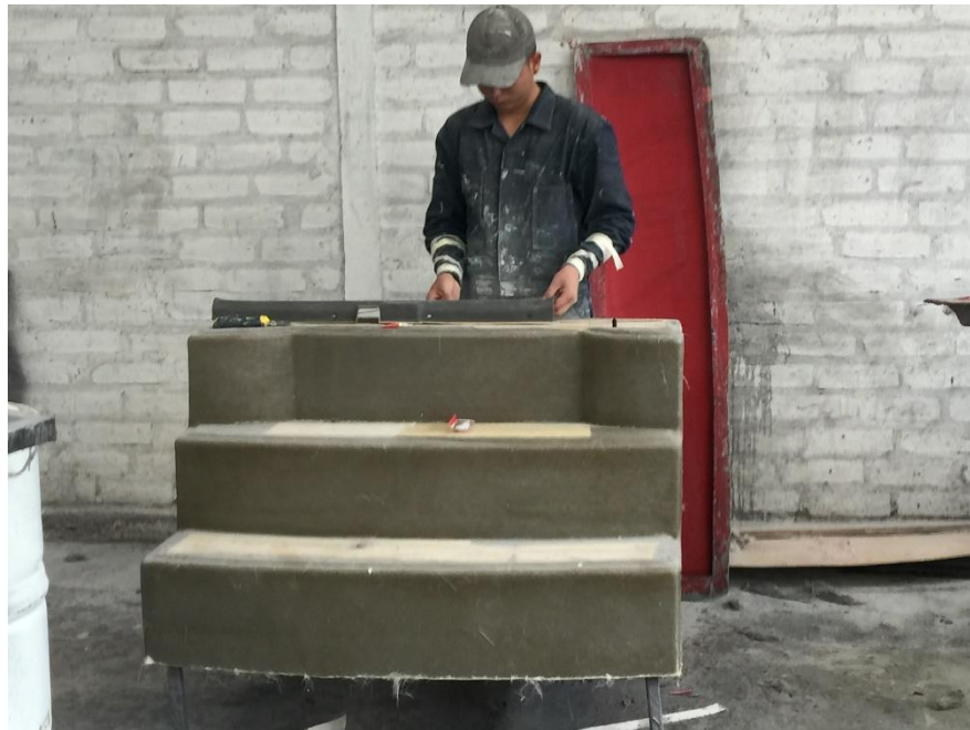
Figura 3 Aplicación de Gel Coat Fuente: Empresa Master Fibra
