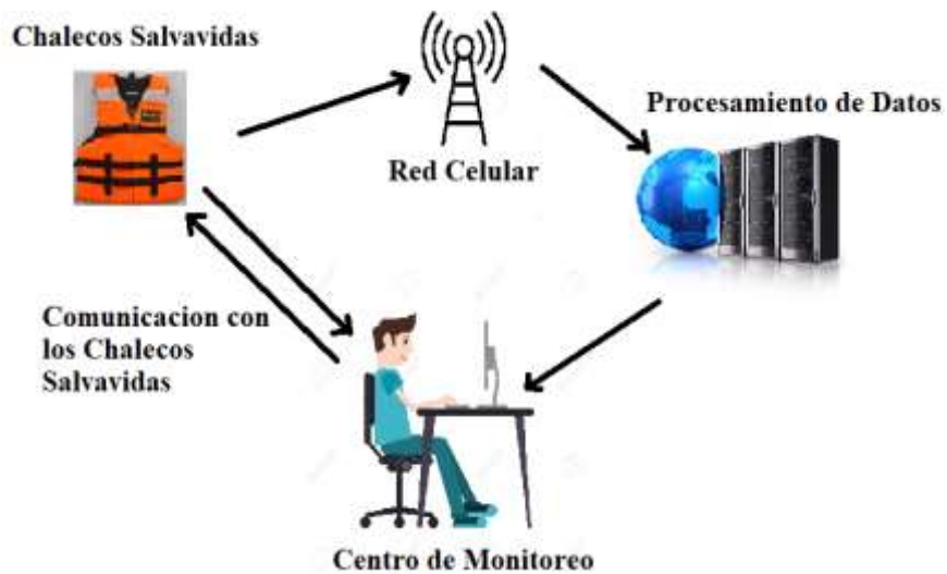
Fig. 4.19 Esquema de Monitoreo de chaleco Salvavidas Fuente: Investigador
