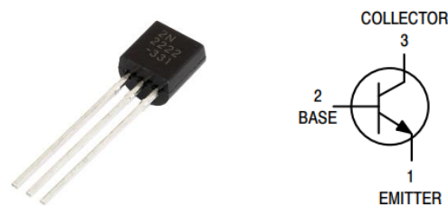
Figura 3.20. Transistor 2n2222a , configuracion de pines [49]
