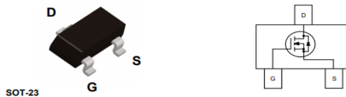
Figura 3.16. Circuito externo/interno del MOSFET BSS138. [44][48]
