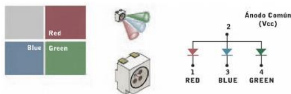
Figura 3.6. Encapsulado SMD de una triada LED RGB [11]
