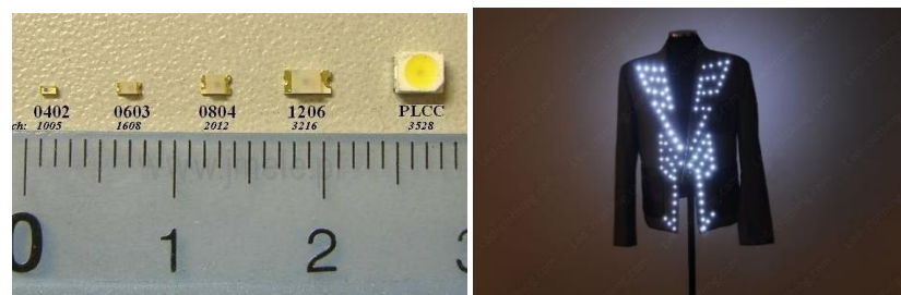
Figura 1.5: Tamaños de leds SMD [11]; Chaqueta con iluminación LED [12]
