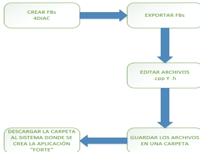
Figura 9 Esquema de configuración y exportación de un bloque funcional
