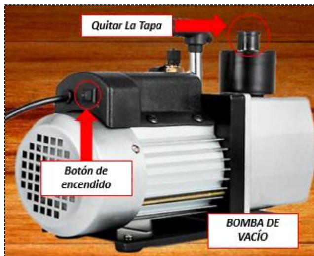
Figura A 4 Encendido de Bomba de Vacío
