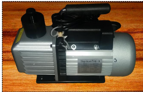
Figura 2.1-5 Bomba de alto vacío
