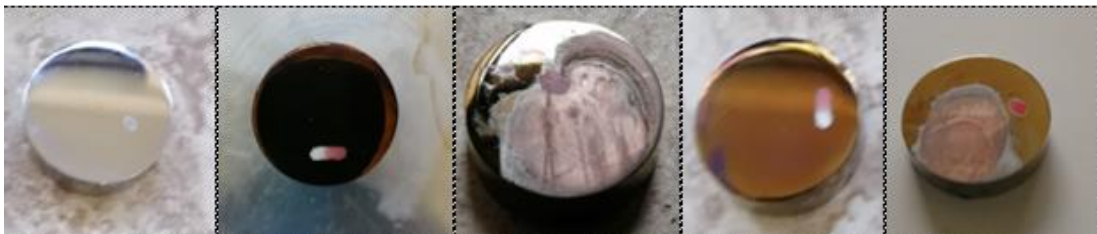
Figura 3.1-30 Recubrimientos de cobre por pulverización catódica obtenidas en probetas de Acero AISI 1018.
