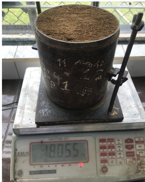
Figura 16: Peso del molde y suelo compactado
