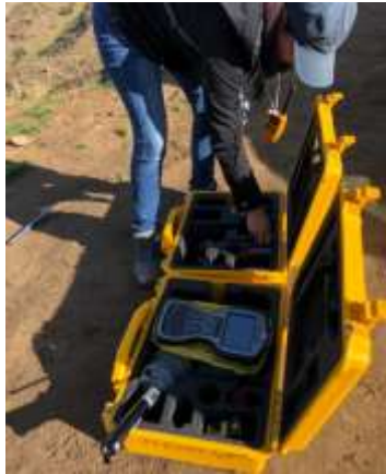
ANEXO B2-3 PREPARACIÓN DE EQUIPO GPS DIFERENCIAL
