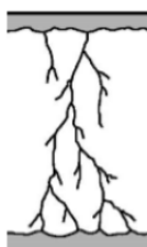
Figura 1. Descarga ramificada en un medio gaseoso [10].
