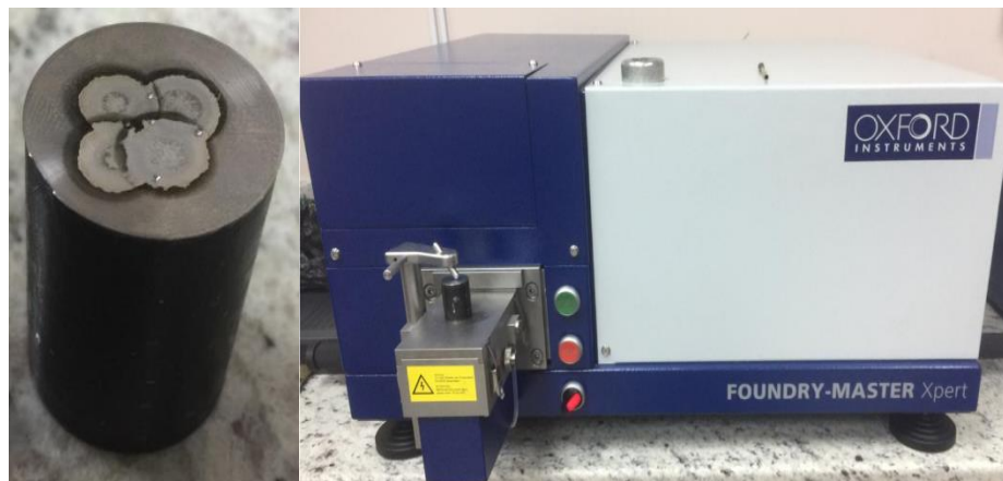
Figura 15. Preparación del espécimen y ejecución del ensayo químico.
