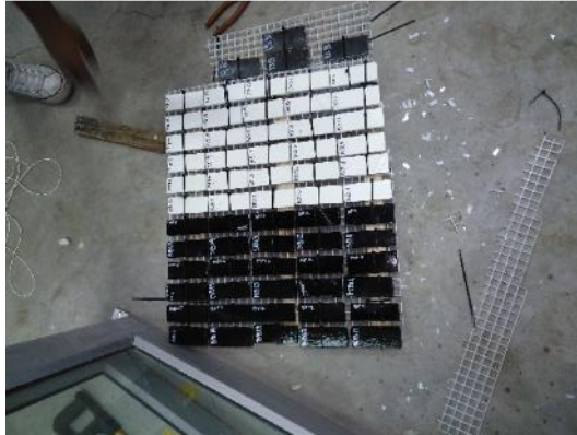
Figura 33. Instalación de probetas en soportes.
