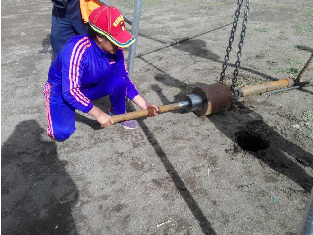
Fotografía 1: Equipo para realizar el Ensayo de penetración estándar (SPT).
