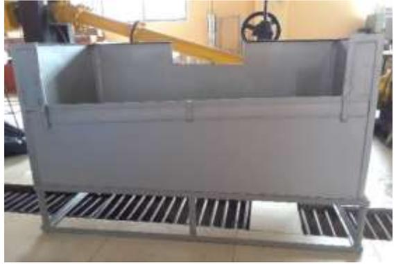
**Anexo 2.-** Tanque disipador de energía (estructura metálica)
