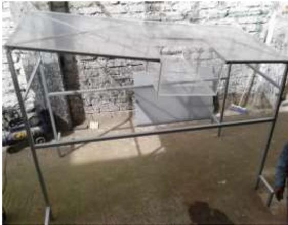
**Anexo 5.-** Construcción de la plataforma niveladora (estructura metálica)
