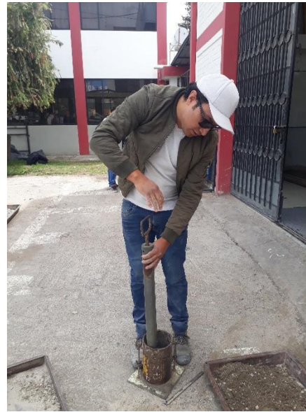
FOTO N°4. Ensayo Proctor Modificado
