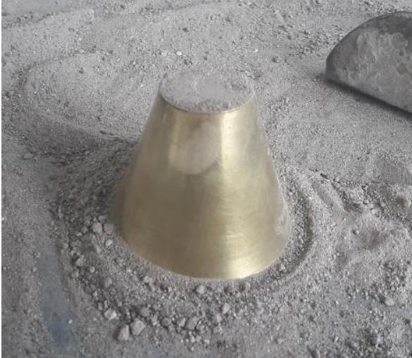
Anexo 1.- ensayo de capacidad de absorción de agregado fino.
