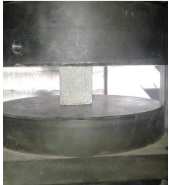
Anexo 10.- Ensayo a compresión de probetas de mortero.
