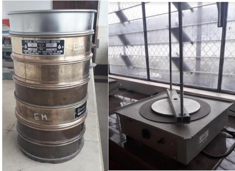
Figura 7.- Tamices y máquina tamizadora
