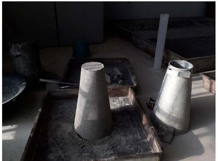
Anexo 12.- Ensayo de consistencia método cono de Abrams.
