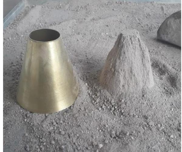
Anexo 2.- ensayo de capacidad de absorción de agregado fino estado SSS.
