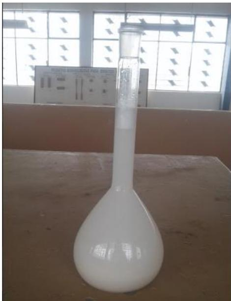
Anexo 7.- Ensayo densidad real de la cal hidráulica.
