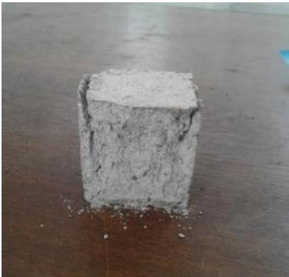
Anexo 11.- Falla presentada de probetas ensayadas a compresión.
