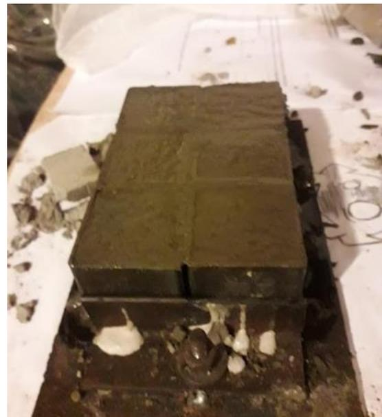
Anexo 8.- Elaboración de las probetas de mortero de cal.
