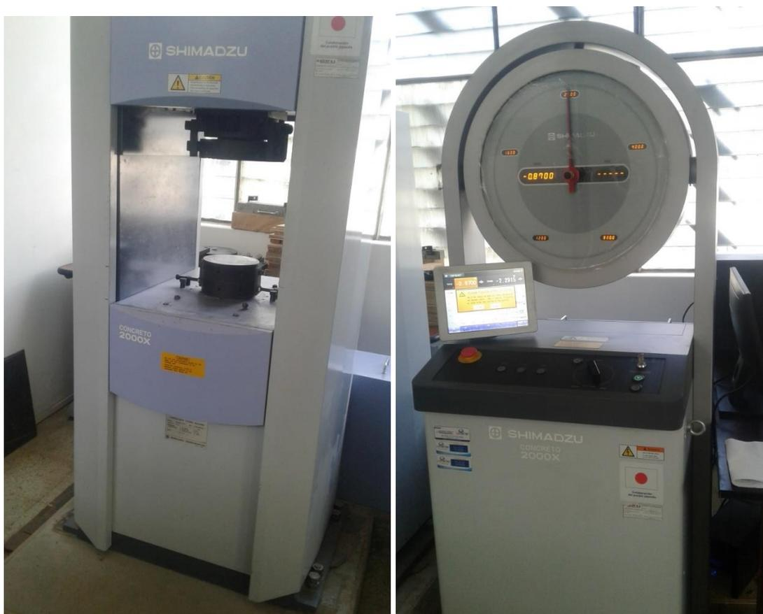
Figura 10.- Máquina de compresión
