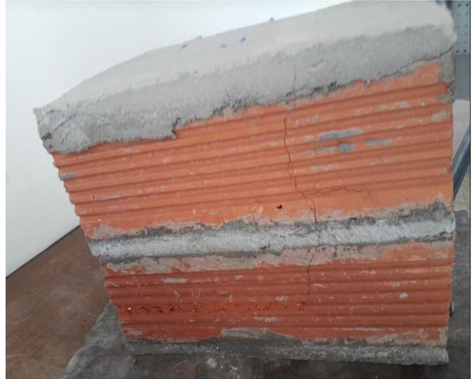
Anexo 14.- Falla observada en ensayo de compresión de mampuestos con mortero.
