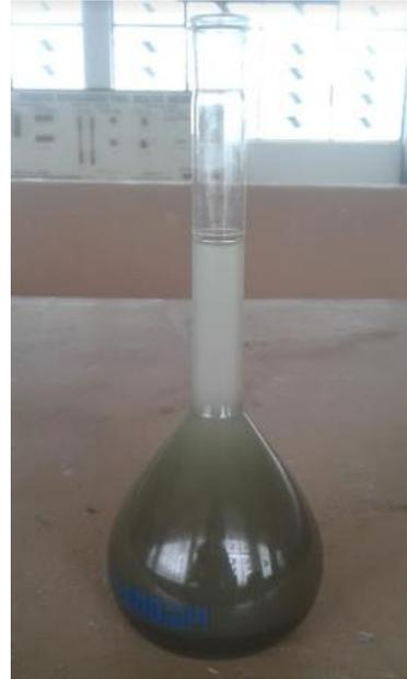
Anexo 6.- Ensayo densidad real del cemento porland.
