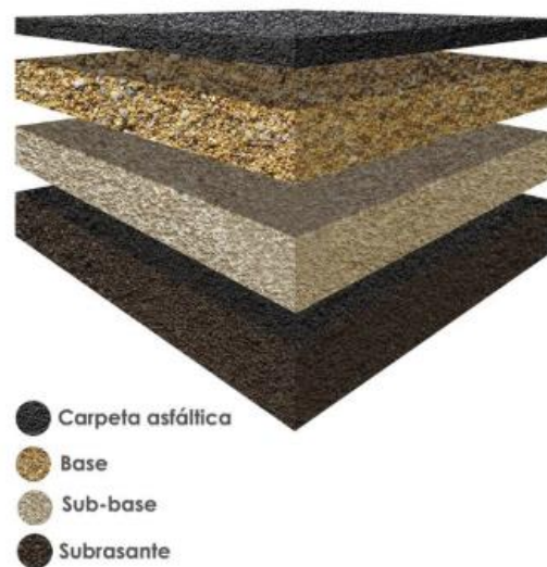
Figura 14. Estructura pavimento flexible
