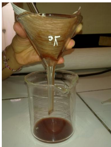
Fot D21. Filtración
