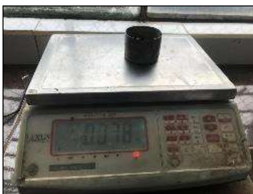
Figura 17: Pesaje de la Muestra después de 24 horas en el horno. Fuente: Alejandro Campaña
