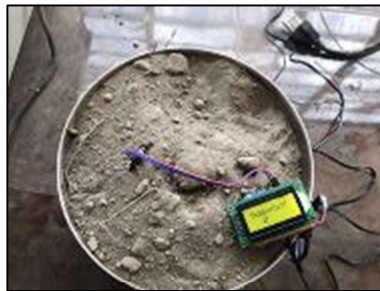
Figura 24: Medición del estado seco de la muestra. Fuente: Alejandro Campaña
