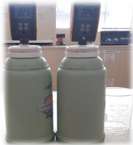
**Imagen 9.** Calorímetro de mezclas (calor específico)
