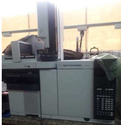
Figura I5. Cromatógrafo de masas Agilent Technologies 7890B GC System, con un detector de masas Agilent Technologies 5977A MSD
