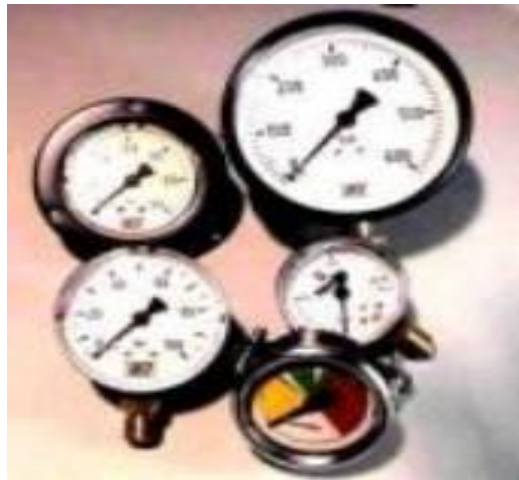
FIGURA 2.11 Manómetros de presión 15
