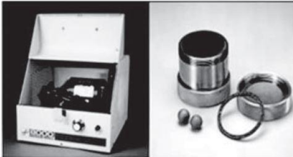
Figura 1. 2: Molino vibratorio SPEX serie 8000 y vial [13].
