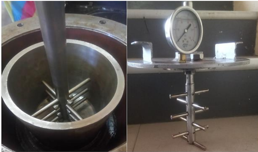
Figura 3. 25: Montaje del sistema de molienda [Autores].
