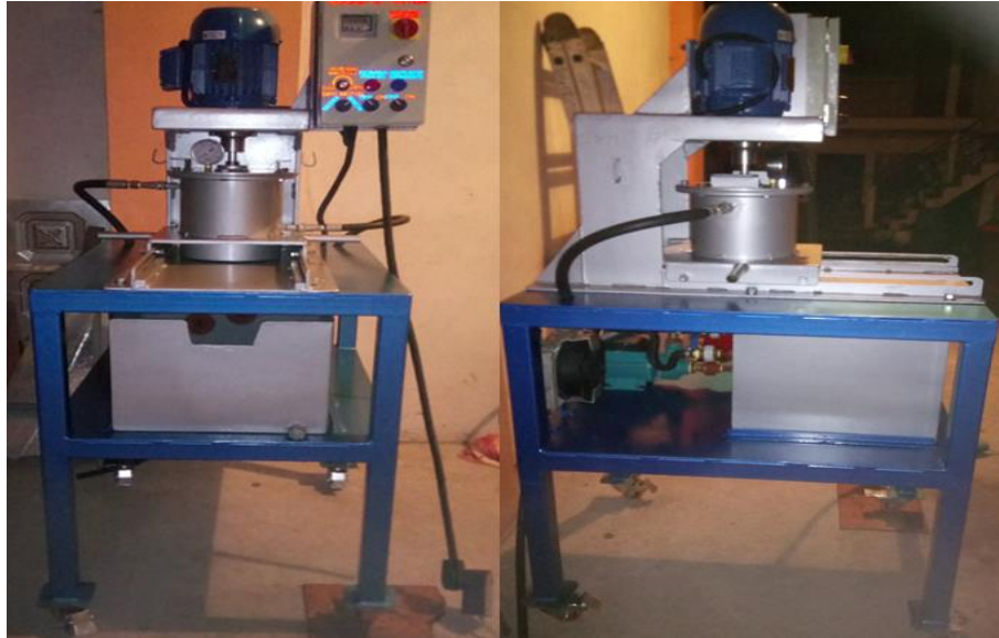
Figura 3. 27: Montaje del sistema de refrigeración [Autores].
