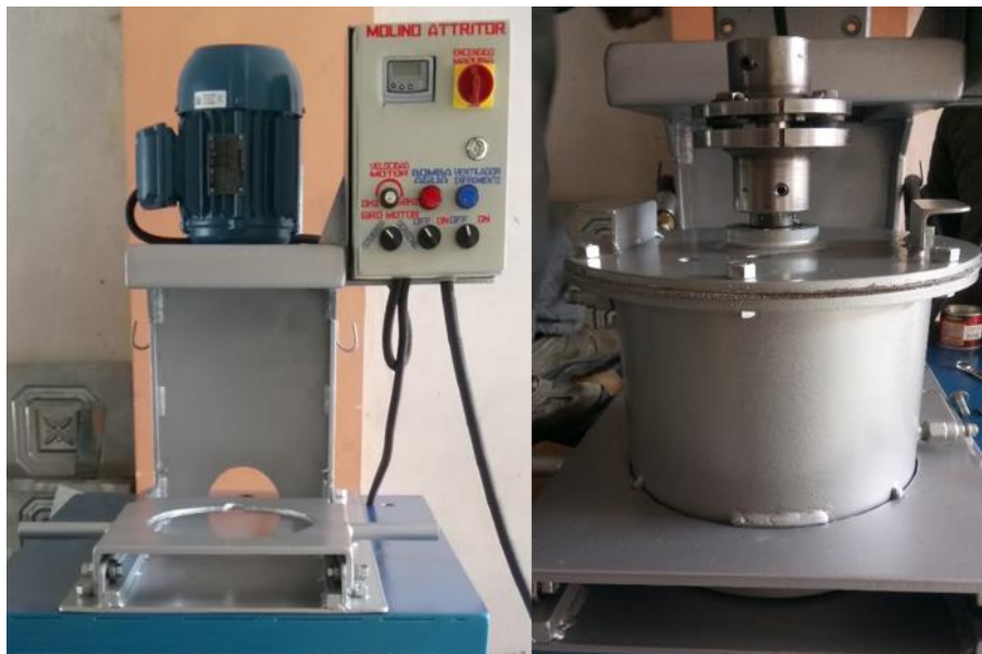
Figura 3. 26: Montaje del sistema de transmisión de potencia [Autores].
