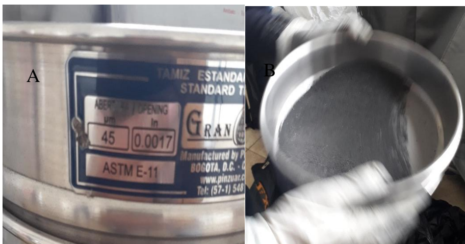
Figura 3. 32: a) Matiz de malla de 45\ \mu\text{m} . b) Tamizado de material molido [Autores].
