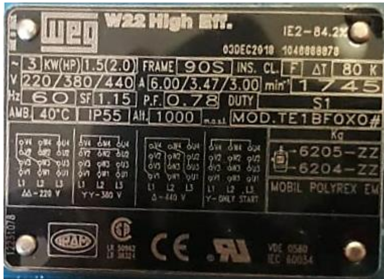
Figura 3. 16: Datos de placa de motor eléctrico WEG modelo TE1BFOXO# [Autores].
