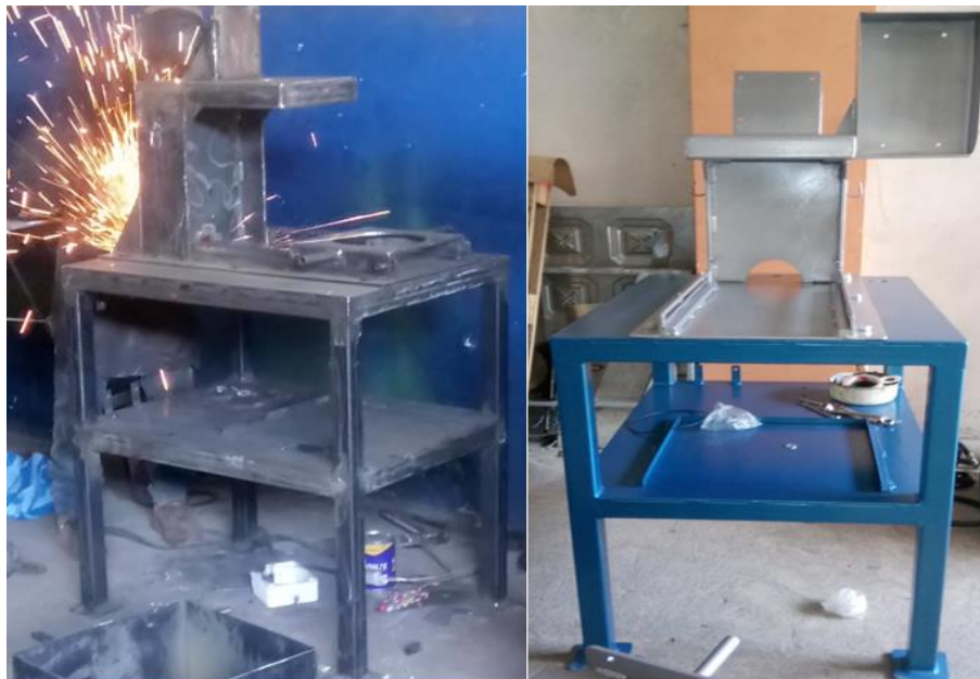
Figura 3. 24: Montaje del sistema de desplazamiento del tanque de refrigeración [Autores].
