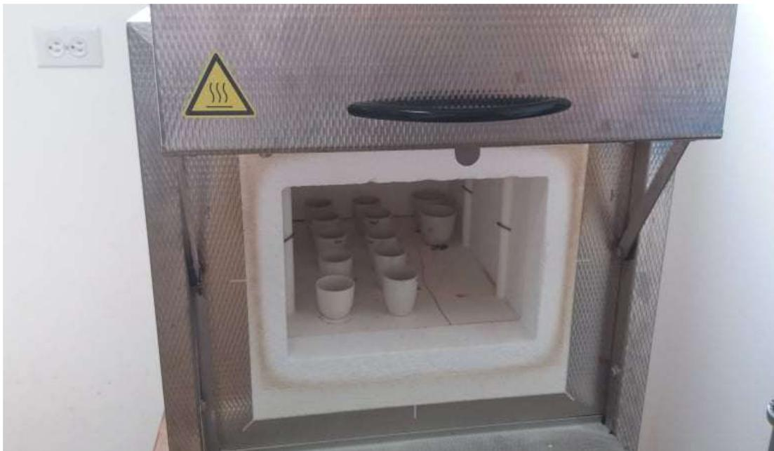
Figura 9 Calcinación y mineralización de las muestras de suelo y zanahoria
