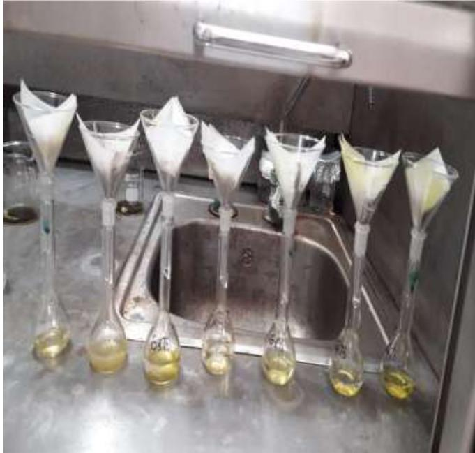
Figura 12 Filtrado de las muestras a ser medidas
