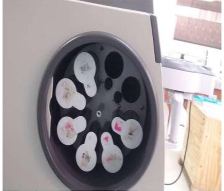
**Figura 10** Lámparas de cátodo hueco para cada metal
