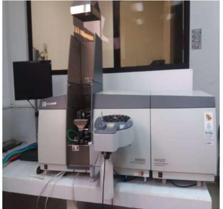
**Figura 11** Espectrofotometro de atomización por llama y horno de grafito
