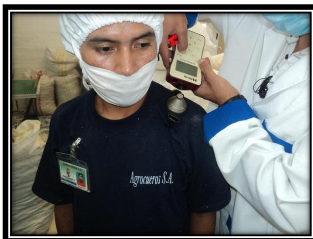
**Figura 4. 16** Procedimiento de parada de toma de datos del dosímetro.
