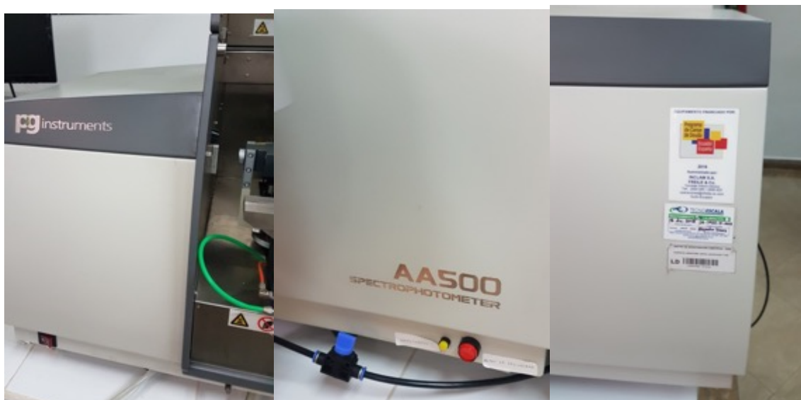
Figura 19. Espectrofotómetro de absorción atómica (PG Instruments, AA500), usado para la cuantificación de calcio según procedimientos descritos por Millán Martín, Abadía Bayona & Heras Cobo (1981).
