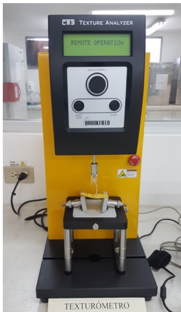
Figura 20. Texturómetro Brookfield (PRO CT 3 , USA), empleado para medir la dureza en Newtons (N) del producto.
