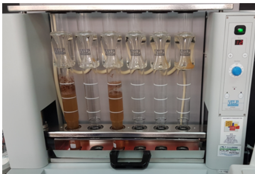
Figura 18. Extracción de fibra utilizando Raw Fiber Extractor de Velp científica.
