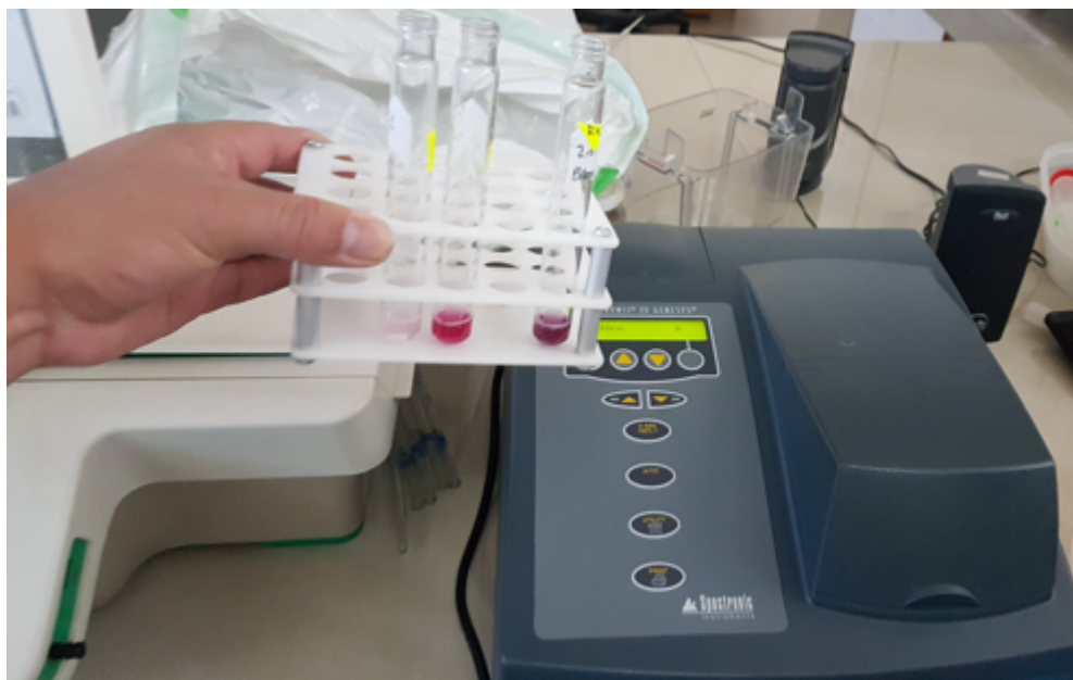
Figura 17. Cuantificación de almidón resistente, utilizando el Kit peridocromo Glucosa y midiendo su absorbancia en el espectrofotómetro Spectronic20 Genesys.
