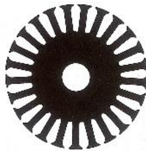
Figura 5. Laminaciones de armaduras con ranuras ahusadas Fuente: [7]
