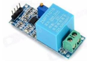
Figura 39. Sensor de voltaje FZ1440 Fuente: [39]
