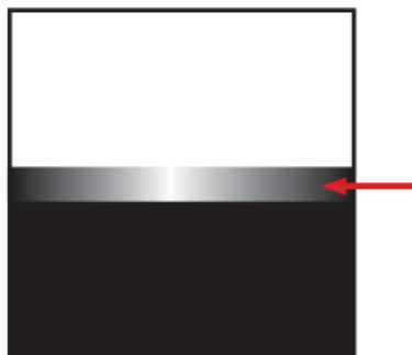
Figura 2-3: Formación de una capa de óxido de cromo en Aceros Inoxidable. [17]
