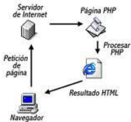
Figura 2.9. Secuencia de un navegador PHP
