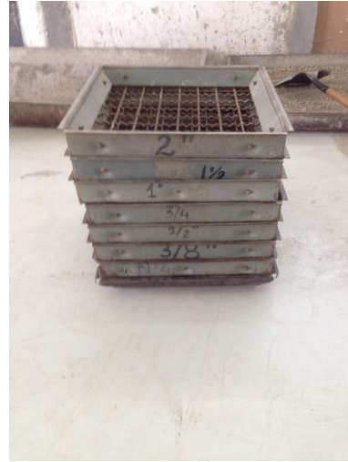
Colocación de tamices en forma vertical.
