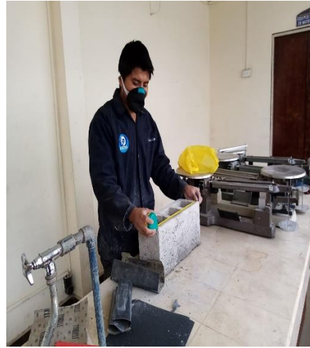
Toma de medidas de las dimensiones del bloque.
