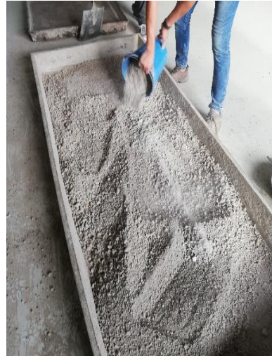
Mezcla de la muestra de material de agregado fino y agregado grueso.
