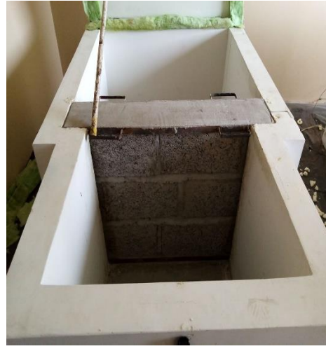
Colocación de pared en la cámara de ensayo.
