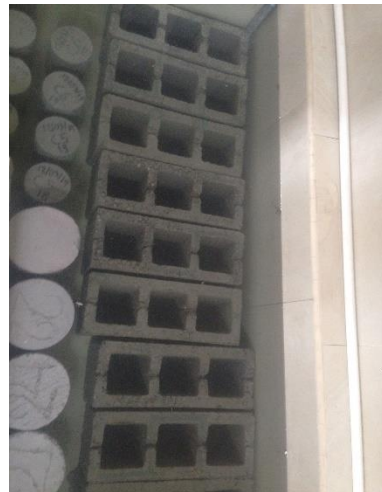
Curado de bloques.
