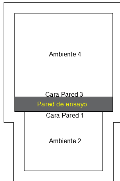
Figura 35. Ubicación de la pared para ensayo térmico
