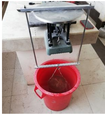
Figura 14. Densidad real del agregado grueso
