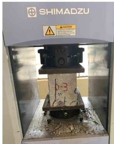
Figura 24. Ensayo de compresión de los bloques
