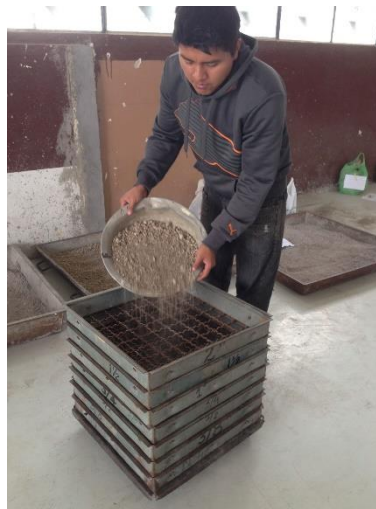
Colocación de la muestra de material en los tamices.
