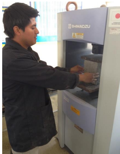
Colocación del bloque en la máquina de compresión.
