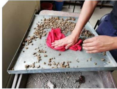
Figura 16. Ensayo de absorción de agregado grueso
