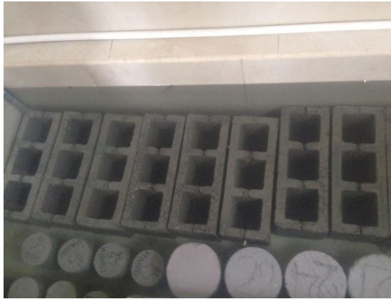
Figura 22. Curado de los bloques
