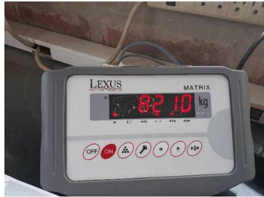
Pesar 8.2 Toneladas como lo establece la norma para el ensayo de la viga Benkelman.
