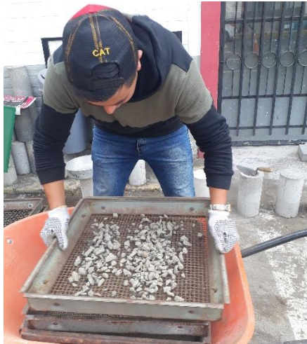
Tamizado del material ensayo granulometría
