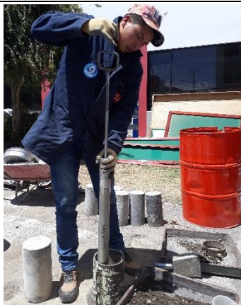
Compactación del material ensayo proctor
