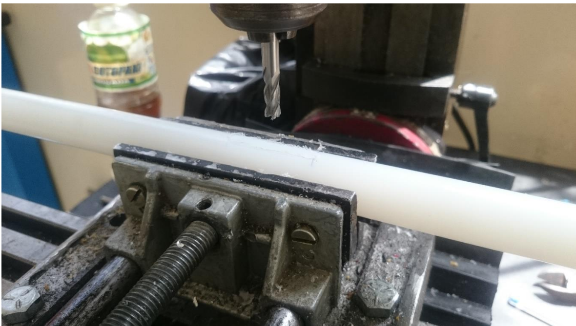
Figura 29: Mecanizado de los orificios para chavetas. Fuente: El autor
