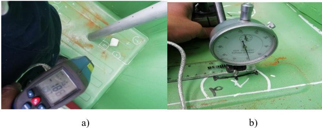
**Figura 4.8** Ensayo de impacto de bola. a) Verificación de temperatura de impacto. b) Medición con palpador magnético. (Fuente: Autor)
