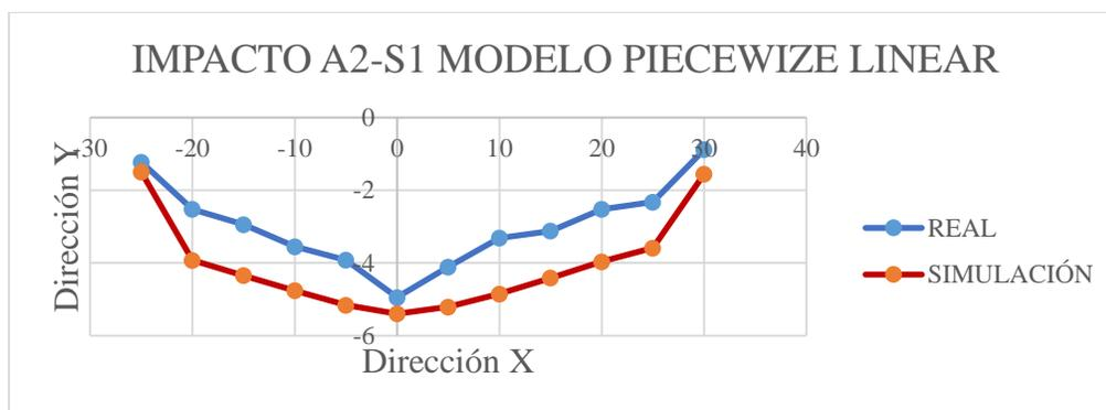
**Figura 4.54** Comparación de deformación real y simulada A2-S1. (Fuente: Autor)
