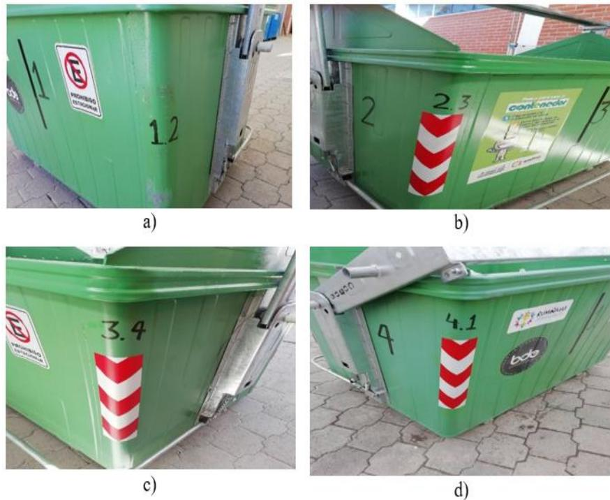
**Figura 4.13** Numeración de las esquinas según la norma UNE EN12574-2 a) Esquina 1.2 b) Esquina 2.3 c) Esquina 3.4 d) Esquina 4.1. (Fuente: Autor)
