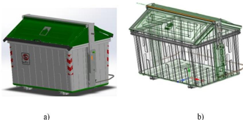
**Figura 3.6** Transformación de modelo. a) Contenedor solido b) Contenedor superficie
