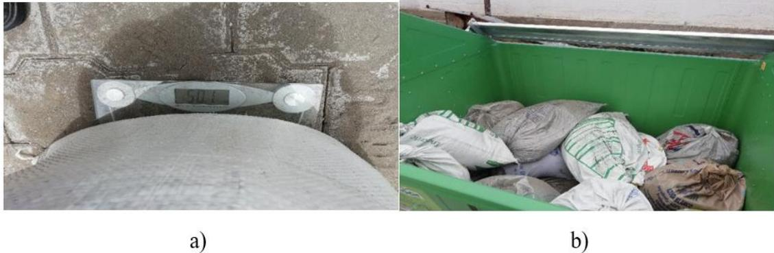
**Figura 4.10** Masa de sacos para ensayo de impacto. a) Medición de masa b) Carga del contenedor. (Fuente: Autor)
