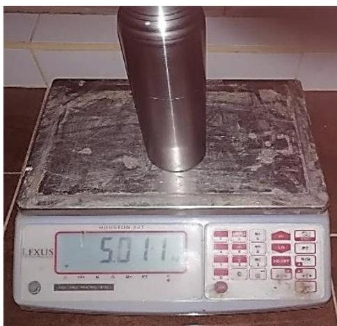
**Figura 3.4** Masa Final de Dispositivo de Impacto. (Fuente: Autor)
