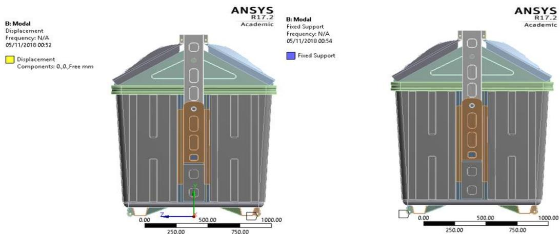
**Figura 4.21** Restricciones de movimiento para estudio estático y modal.(Fuente: Autor)
