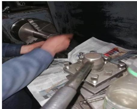
**Figura 3.3** Maquinado del eje de acero 1018. (Fuente: Autor)
