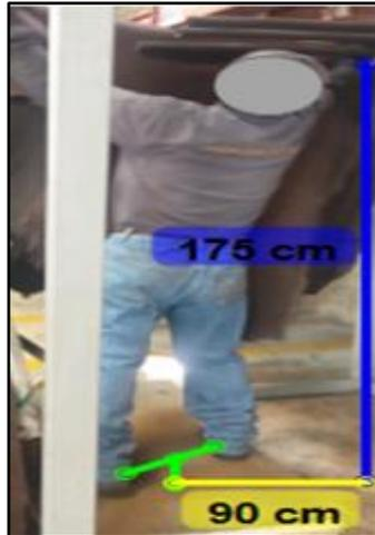
Figura 73: Distancia horizontal y vertical en el destino de la carga
